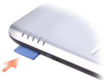
计算机能够识别存储卡，并自动载入相应的设备驱动程序。如果配置程序提示您载入制造商提供的驱动程序，请使用存储卡附带的介质（如果有）。
