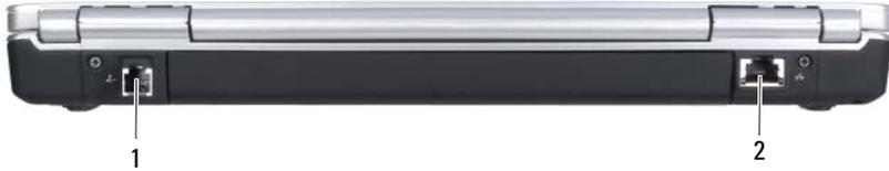
1 调制解调器连接器 (RJ-11)      2 网络连接器 (RJ-45)
